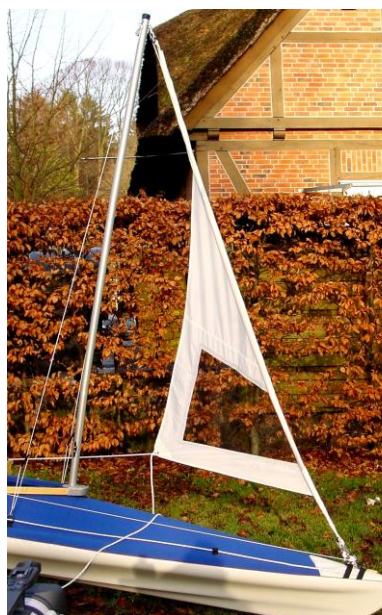
Sie sehen auf obigen Bild nicht nur eine teilweise aufgerollte Fock, sondern eine gereffte Fock.
